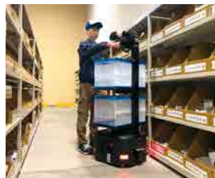
自律走行搬送ロボット(AMR)との協働作業
