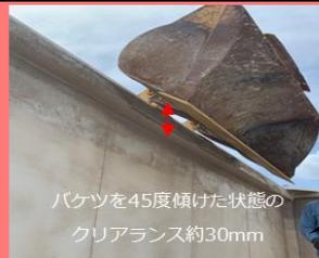
コンテナに接触することはギリギリ無かった。安定した作業を行うためにも同機よりもヒンジピンの高さが+300mm以上ある機種(同機種 スーパーロング仕様等)を推奨します。
