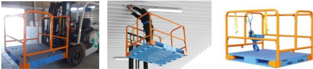
専用の作業台をフォークリフトに取付けることで、高所作業を行う際の安全な足場を確保できます。
